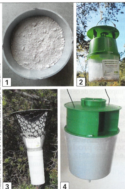
▲ Pièges installés sur le dispositif 2017 en forêt domaniale du mont Ventoux : 1. Piège Procerex rempli avec de la terre de diatomée Rampa'Clac (Protecta). 2. Buxatrap. 3. Mastrap L. 4. Procerex.
